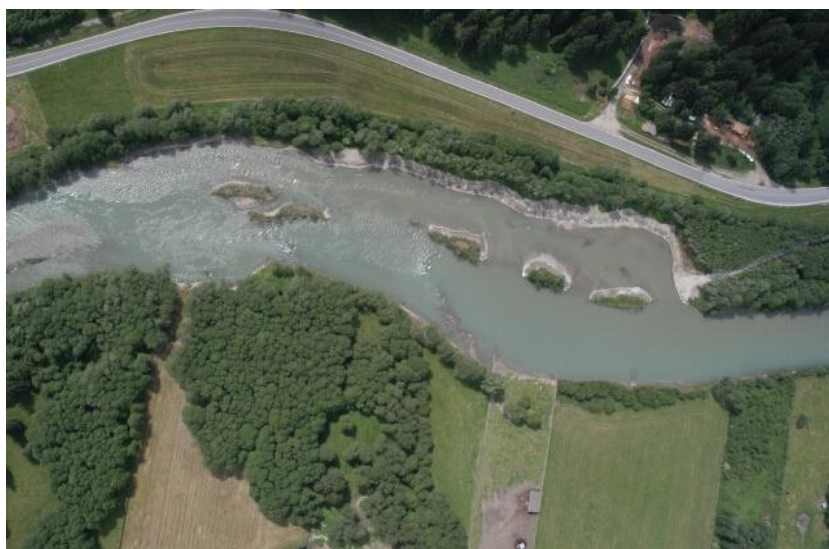
Ampliamento dell'alveo del Torrente Aurino a Tures © Provincia Autonoma di Bolzano
