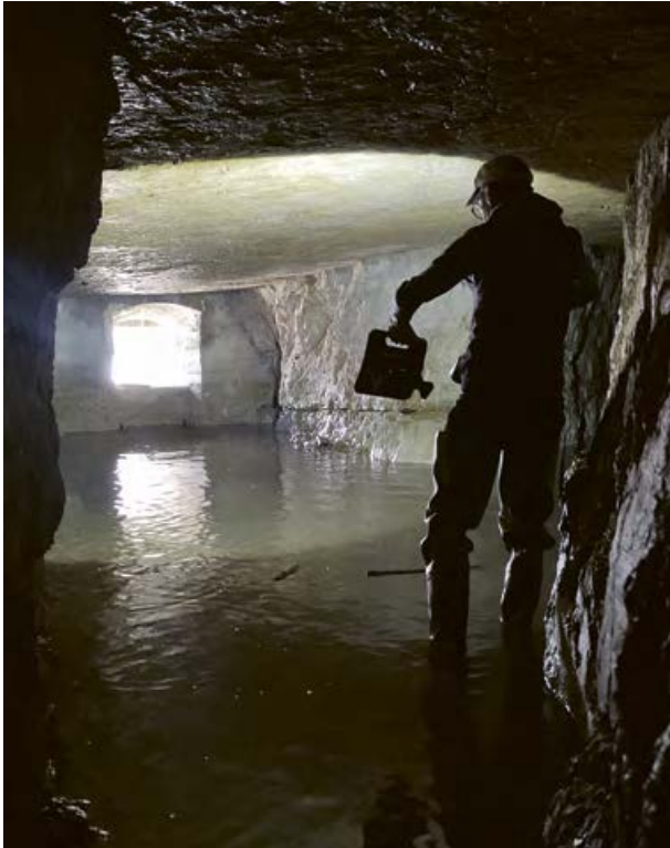
3 3D-Vermessung im Goinger-Stollen. © 2021, unibz, WIL Archive. Abdruck mit Genehmigung.
